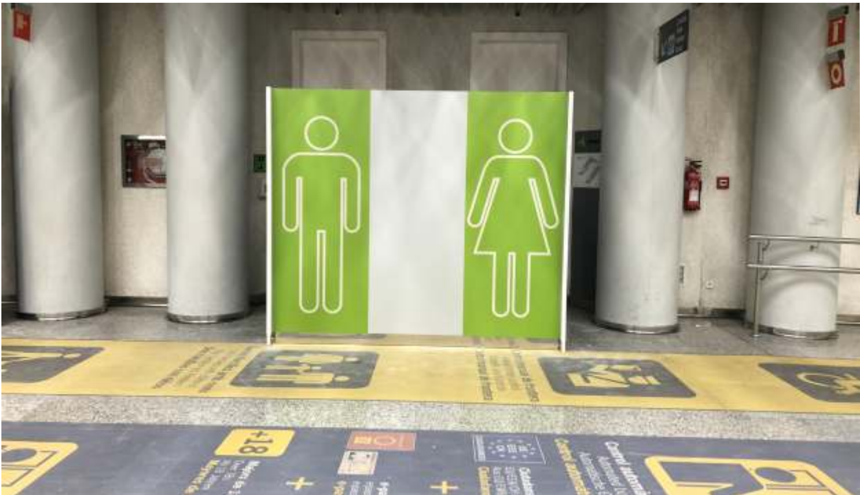
Mamparas de ocultación de aseos. En pvc de 30mm, impresión directa y barnizado. Soportes en acero inoxidable. Aeropuerto de Palma de Mallorca -AENA.
