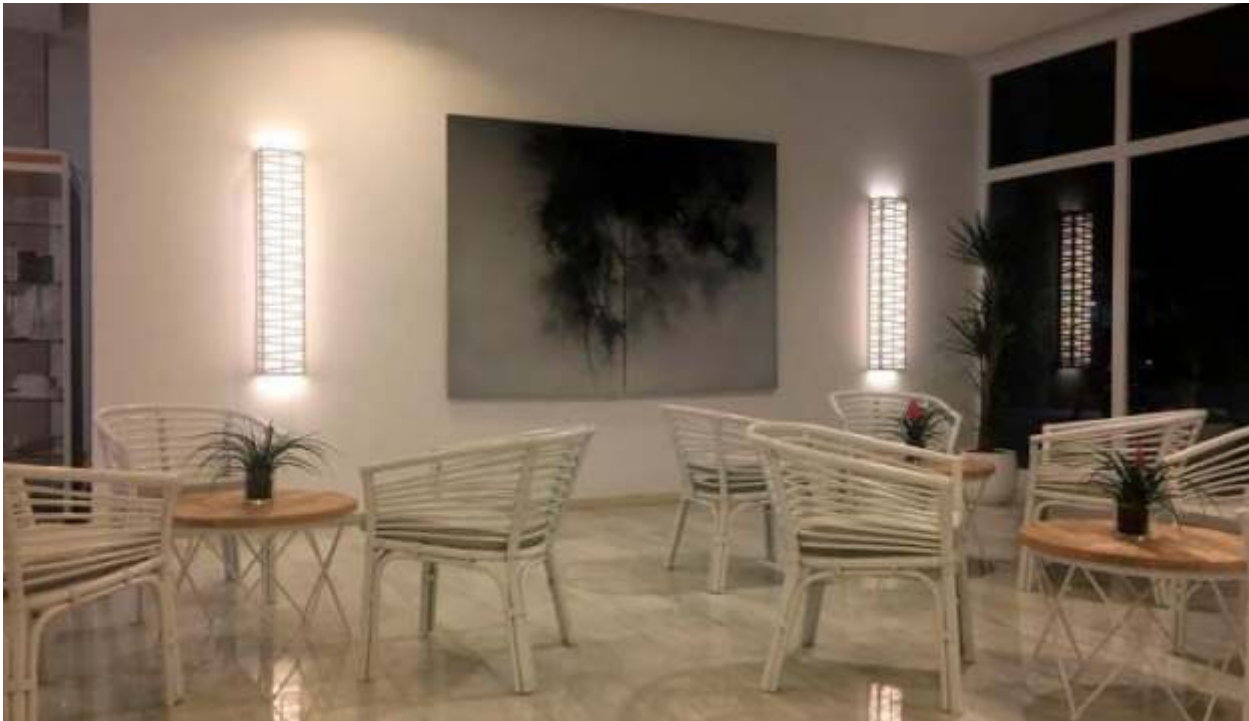
Plafones de luz, fabricados en pvc de 8mm, fresado, doblado y pintado blanco mate. Iluminación interior mediante leds de luz cálida. Grupotel
