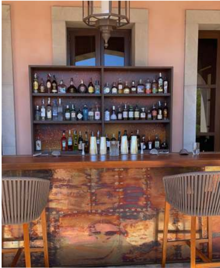
Trasera para mueble de bar. En metacrilato de 5mm, blanco opal con impresión directa especial para iluminar. Cap Vermell Grand hotel - Restaurante ROKA
