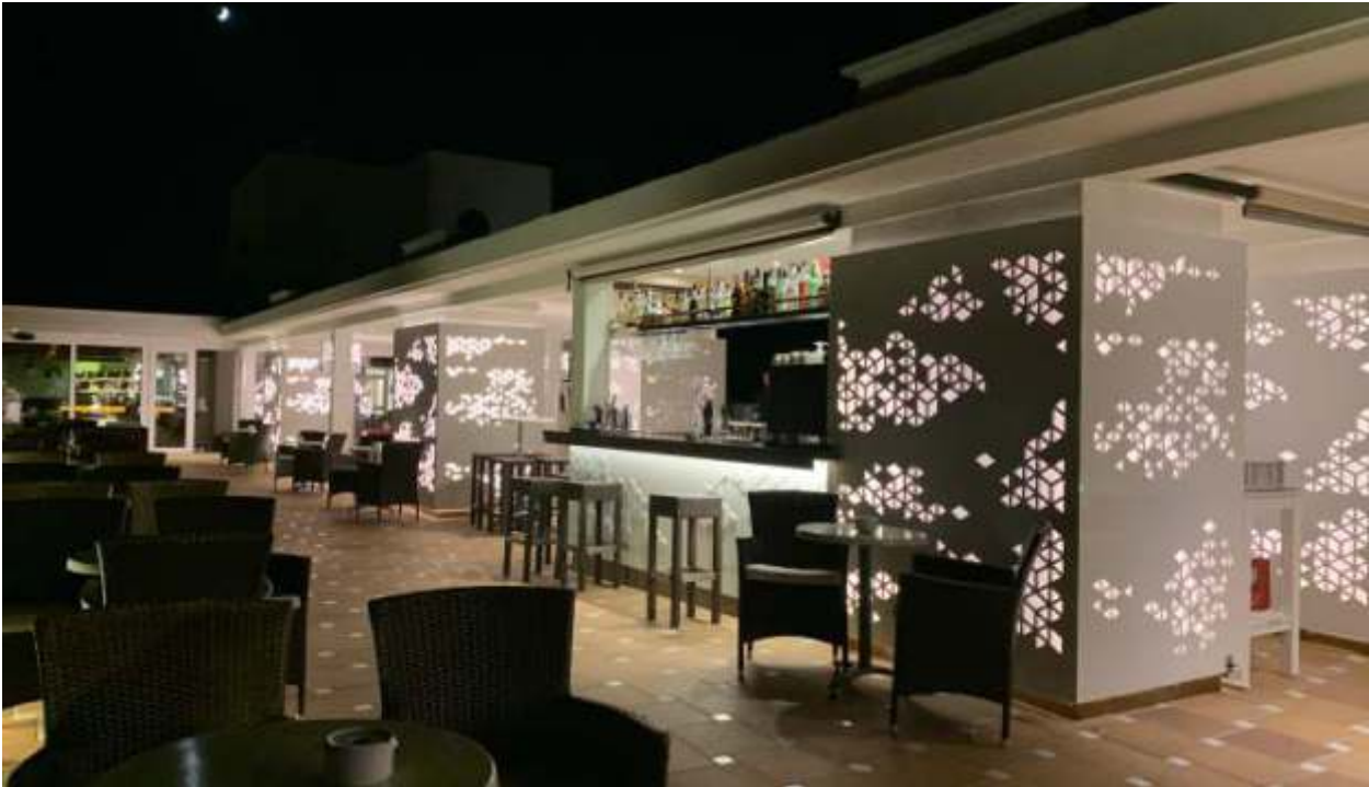
Paneles de forex de 8mm, fresados y pintados blanco mate. Com metacrilato blanco opal e iluminación con leds de luz natural. Grupotel
