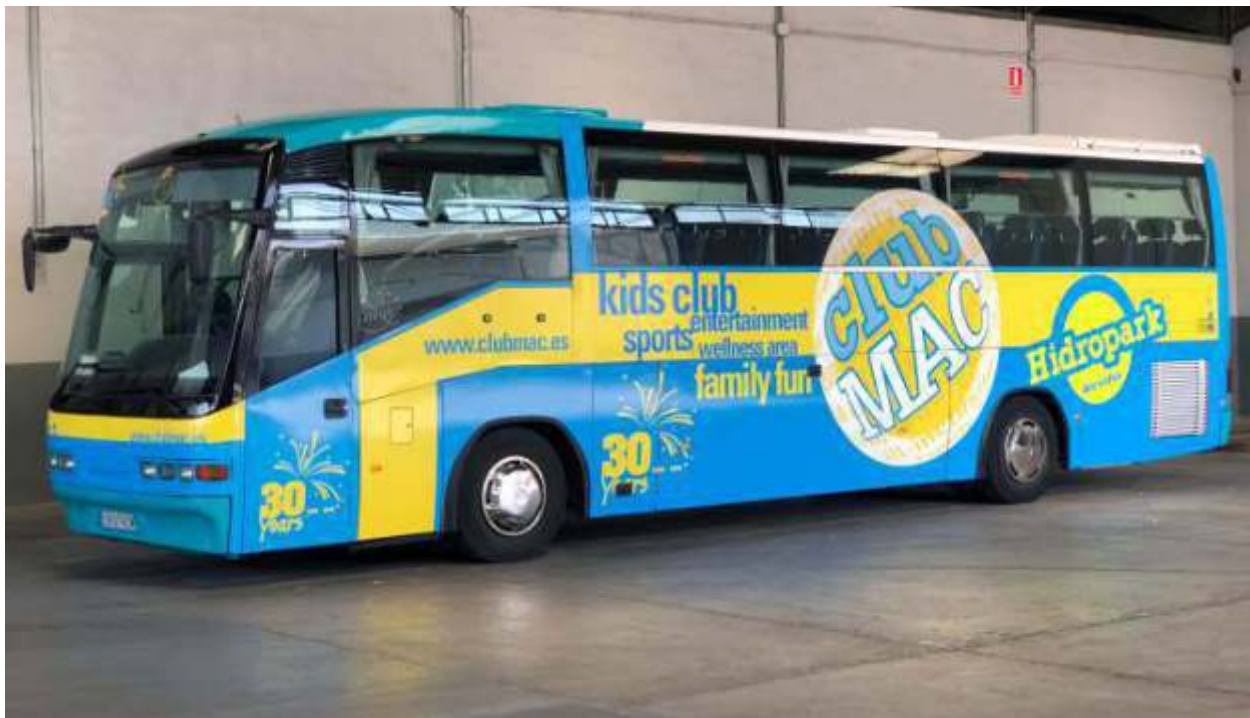
Rotulación integral de autocar. Combinación de vinilo impreso y laminado protector especial para la carrocería y vinilo microperforado para las ventanas.
