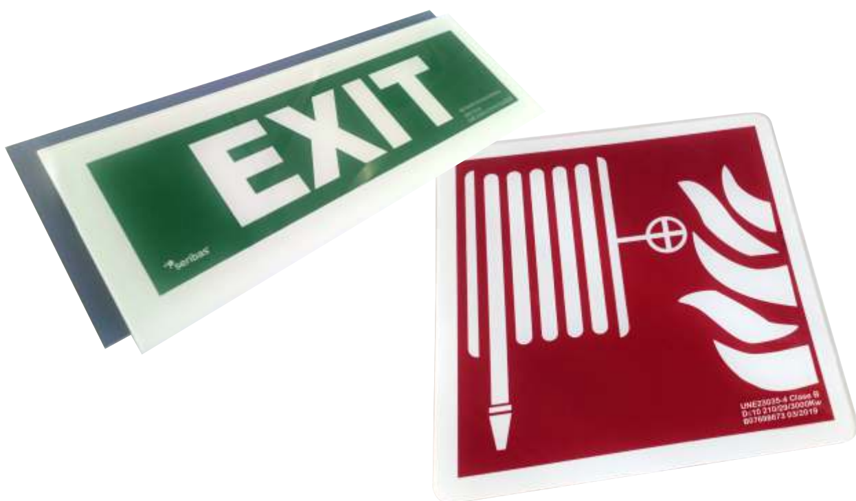
Señales de emergencia en metacrilato de 3mm, impresión directa y serigrafiado fotoluminiscente. Trasera en pvc de 4mm pintado.
