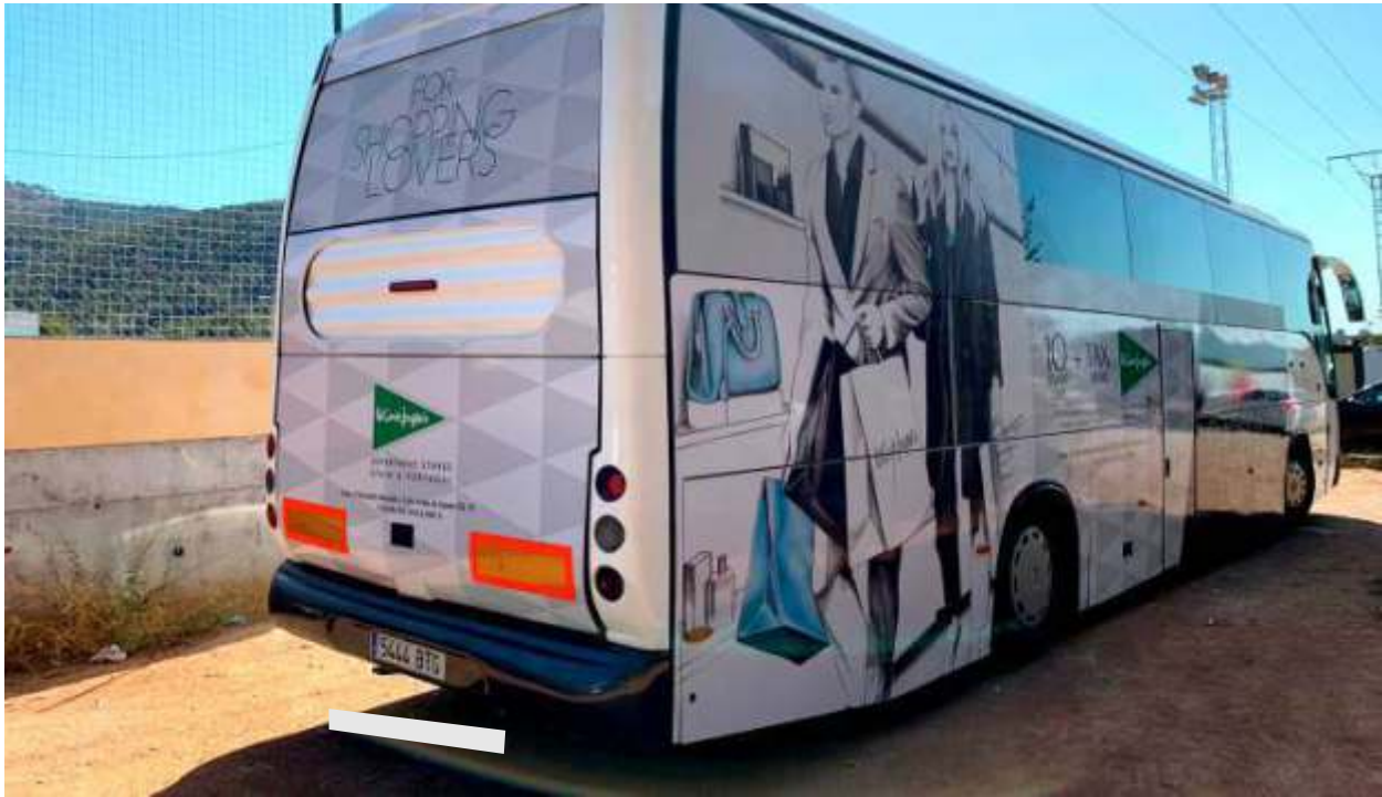
Rotulación eventual integral de autocar. Combinación de vinilo removible impreso y laminado protector especial para la carrocería y vinilo microperforado para las ventanas.
